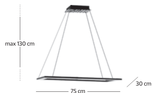
art. KLAQ S 75 telaio altezza regolabile / frame with adjustable height max 12 cablaggi CP 200 / max 12 cables CP 200
