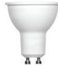
LB943 -GDH GU10 2700K 8W - 660lm - 220V fascio di luce 60° light beam 60° vetro chiaro clear glass dimmerabile dimmable CRI >90Ra
