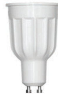
LB939 -GPN POWER GU10 3000K 12W - 940lm - 220V fascio di luce 60° light beam 60° vetro chiaro clear glass dimmerabile dimmable CRI >90Ra
