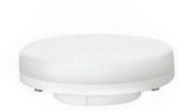
LB950 -XLN GX53 3000K 6,5W - 700lm - 220V fascio di luce 110° light beam 110° vetro opale opal glass non dimmerabile not dimmable CRI >90Ra
