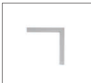
Lavorazione taglio ad angolo 45° dei profili 45° cutting of the profiles
