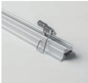
Molla per incasso controsoffitto e controcassa Foro incasso larghezza 19 mm: Posizionare inizio-fine +1 ogni 50 cm. Spring for recessed ceiling. Recessed hole width 19 mm. Place: beginning, end and 1 every 50 cm
